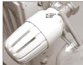
Cu ajutorul cheii hexagonale SW 2, strâneți cele două șuruburi vizibile prin crestăturile inelului cu nervuri ②. Capul termostatic este acum fixat pe robinet. Pentru mascarea șuruburilor de siguranță, inelul cu nervuri poate fi rotit în orice poziție.
