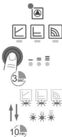
Umpleți și aerisiți corect sistemul. Dacă pompa nu se aerisește automat:
