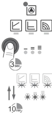
Umpleți și ventilați sistemul corect. Dacă pompa nu se aerisește automat:
